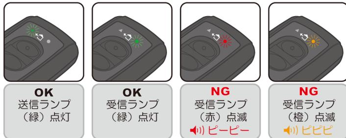
※正しい操作の場合は、送信ランプ（緑）の点灯後、受信ランプ（緑）点灯が完了です。NGの場合は、動作モードにより条件が異なります。設置マニュアルにてご確認ください。
